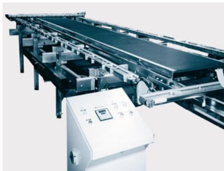
a) Barras de fixação: graças à sua força progressiva, elas impedem que o tecido deslize. Os valores de tensão ajustados (N/cm) são transmitidos eletronicamente à força do motor.
