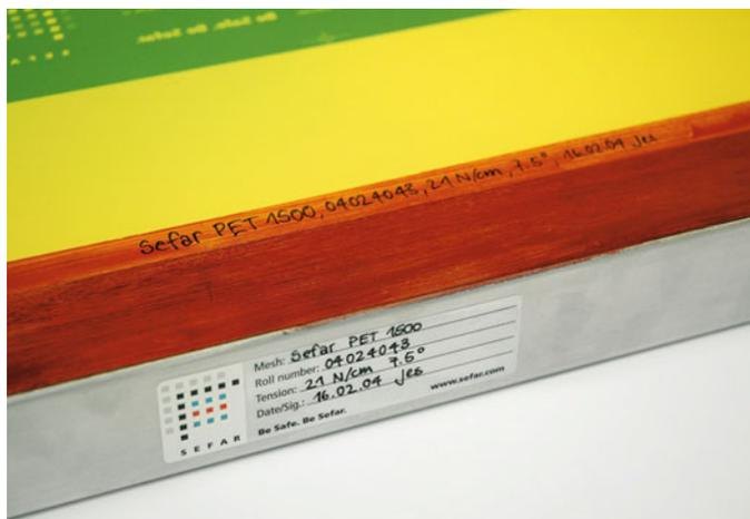
Uma etiqueta com as mesmas informações colocada na parte frontal do quadro serigráfico torna mais fácil encontrá-lo no depósito de quadros. A etiqueta pode ser de película auto-adesiva ou de papel auto-adesivo e as informações devem ser escritas com uma caneta de ponta de feltro à prova d'água. Para protegê-la, é possível usar uma fita adesiva à prova de solventes.
