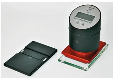
A qualidade das impressões serigráficas depende em muito de uma esticagem perfeita e controlada das telas. O Tensocheck 100 da SEFAR® mostra imediatamente a tensão do tecido em valores digitais em Newton/cm ou em mm em um display de grandes dimensões. A sua estrutura robusta e precisa garante a produção de valores de tensão fiáveis e exatos. A gama de controle é de 4 a 60 N/cm (2.75–0.4 mm).
