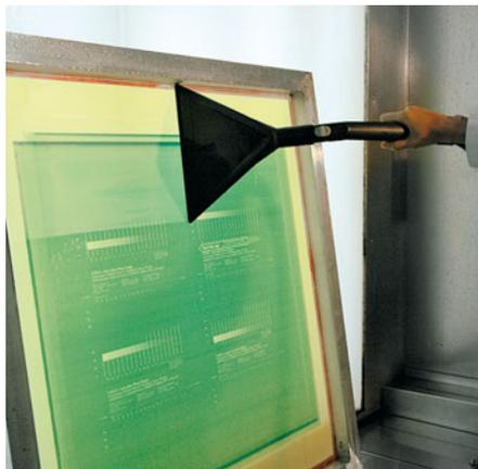
O excesso de umidade da matriz deve ser removido com um aspirador de água. Desta forma se evita a formação de um véu e o tempo de secagem se reduz substancialmente.
