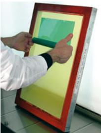
O filme é colocado sobre uma base plana com o lado da emulsão voltado para cima. A tela úmida é então colocada cuidadosamente em contato com o filme. Através da ação capilar, o filme é absorvido pelo tecido. O excesso de umidade deve ser retirado com um rodo. Em formatos de grandes dimensões, é aconselhável enrolar o recorte do filme de forma bem justa para que ele possa ser desenrolado sobre a tela úmida na vertical.
